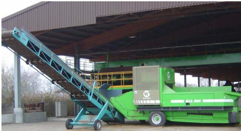
Schredder – Anlage für Kompostieranlage
